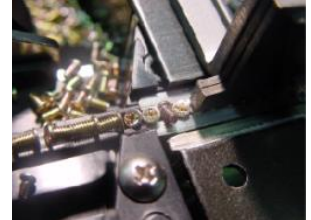
供給量が多すぎてレール部での反転ができない 図8
